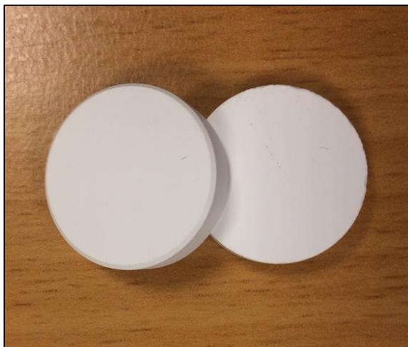
شکل ۱: نمونه‌ای از دیسک متخلخل نیمه تراوا ساخت شرکت وینچی ( www.vinci-technologies.com ).
