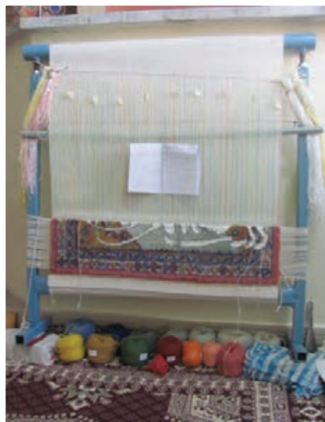
شکل ۱۰-۱- زیر دار ثابت و سردار متحرک (مدل ۲)
