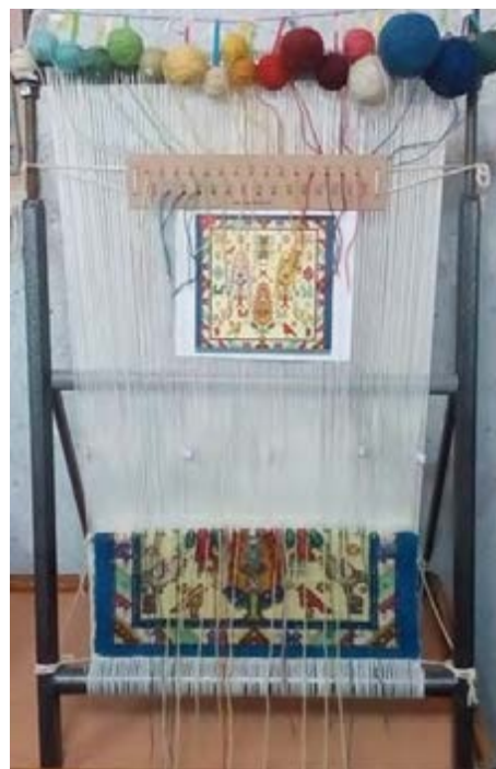
شکل ۹-۱- زیر دار ثابت و سردار متحرک (مدل ۱)
