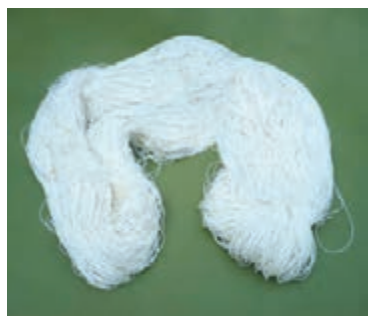
شکل ۱۳-۲- ۱۰۰ گرم چله ابریشمی ۴۲ شکل ۱۴-۲- ۱۰۰ گرم چله ابریشمی ۳۶ شکل ۱۵-۲- ۱۰۰ گرم چله ابریشمی ۳۰ (لا(رجشمار ۵۰) لا (رجشمار ۶۰) لا(رجشمار ۷۰)
