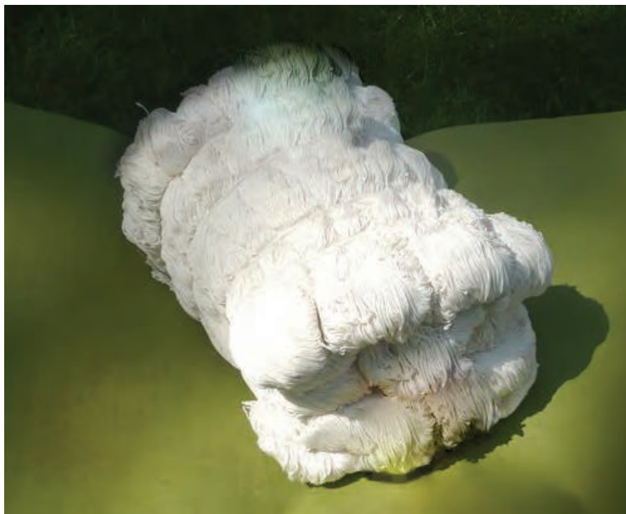
شکل ۱-۲. یک بقچه (حدود ۴ کیلو ۴۰۰ گرم) نخ چله پنبه ای دوازده لا، نمره ۲۰
