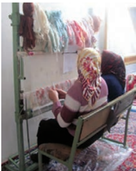
شکل ۱۲-۱- زیر دار و سردار هر دو گردان (شفتی)
