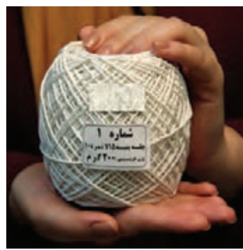
شکل ۱۷-۲- توپک ۲۰۰ گرمی، چله پنبه ای ۱۵ لا نمرة ۱۰
