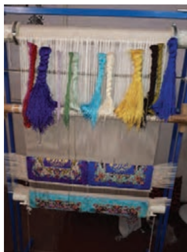
شکل ۳۳- ۵- سر دار و زیر دار هر دو گردان
