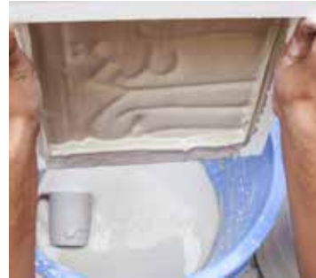
خالی کردن دوغاب گل Pouring out the clay grout
