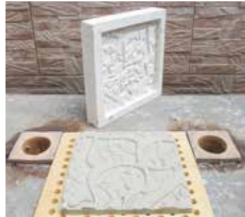
قالب و نمونه تکثیر شده The mold and the reproduced sample
